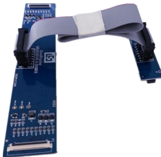
图 9 Raspberry Pi-C1248 与 DESPI-C1248 连接方式
