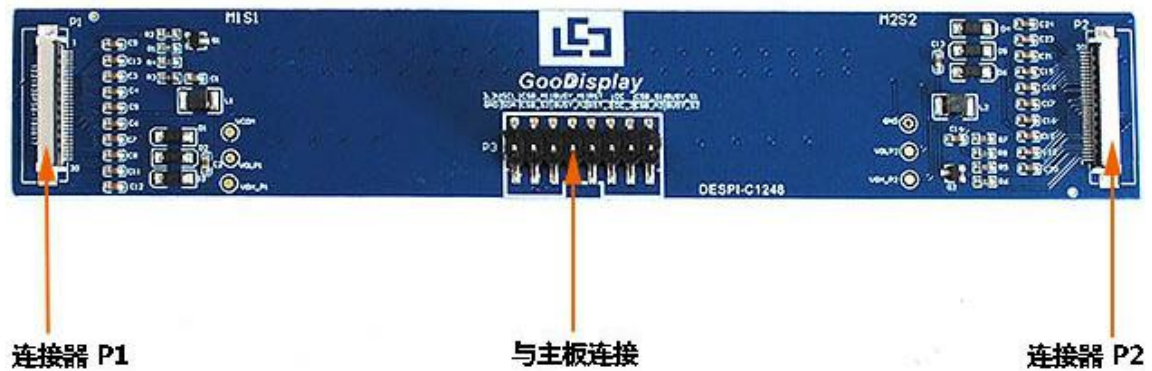
图 1 转接板 DESPI-C1248 功能图
